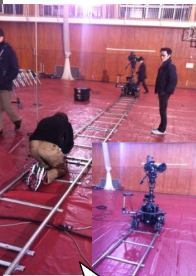
ドリーカメラ 線路の上を移動します
